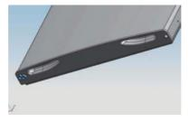
4) Quite los tornillos que sujetan la bisagra inferior con un destornillador de estrella.
